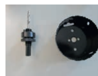
wiercenie otworu \phi 102 \text{ mm}
