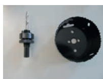
wiercenie otworu Ø 102 mm
