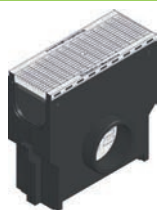
studzienka z ocynkowanym osadnikiem, rusztem kratowym MW 30/10, ocynk., kl. B 125
